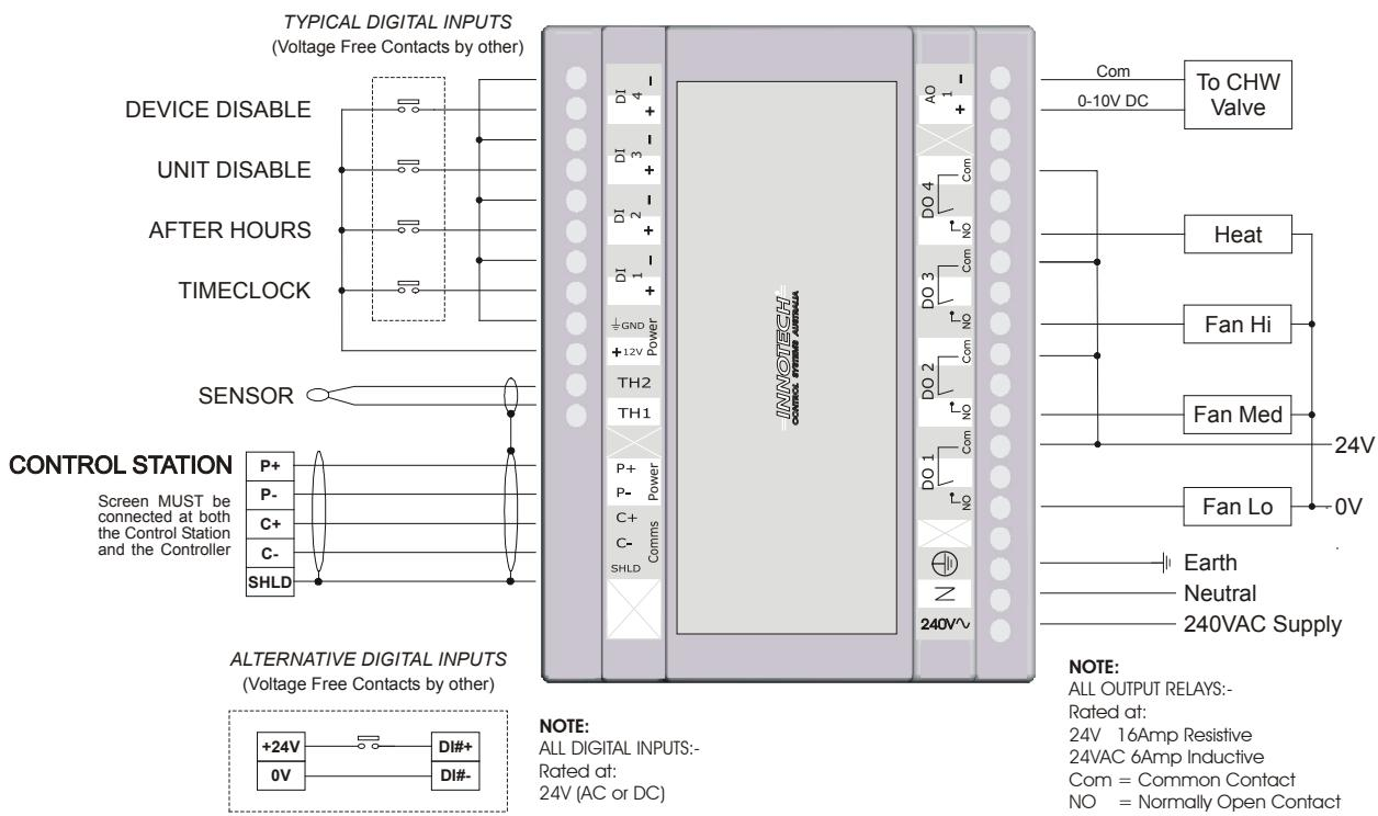
\* MAXIMUM CABLE LENGTH BETWEEN THE CONTROL STATION & CONTROLLER IS 50 METRES.
